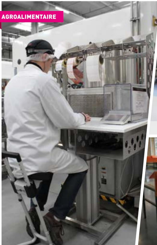
Poste réglable en hauteur sur colonne télescopique
