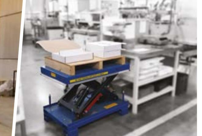
Table élévatrice sur embase palette pour la mise à hauteur au poste de conditionnement
