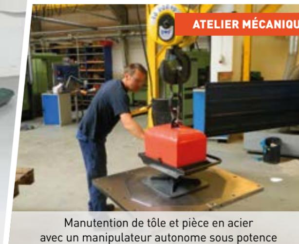
Manutention de tôle et pièce en acier avec un manipulateur autonome sous potence
