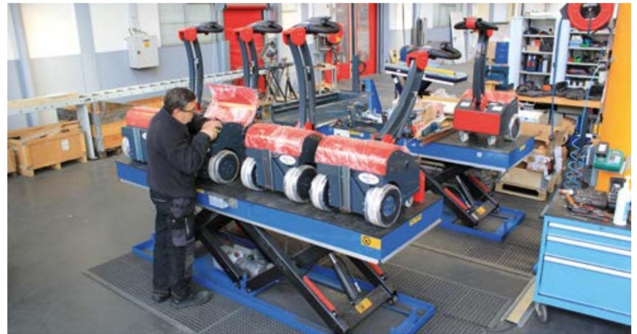
Table élévatrice pour l'assemblage en production
