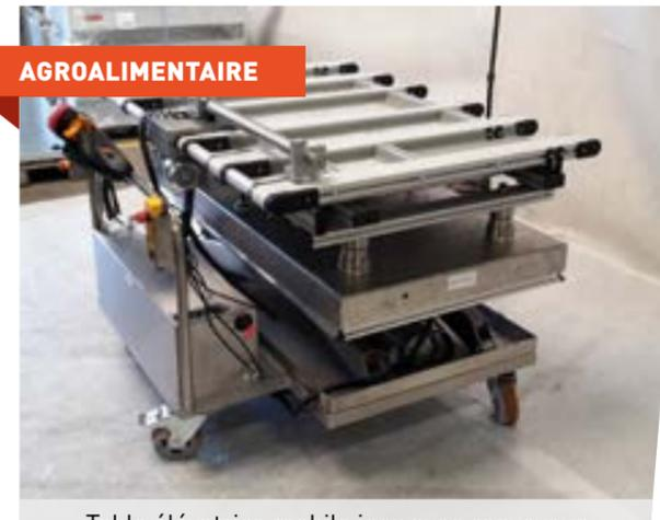
Table élévatrice mobile inox avec convoyeur motorisé et déplacement motorisé
