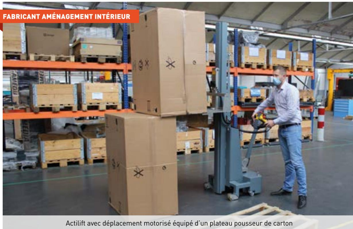
Actilift avec déplacement motorisé équipé d'un plateau pousseur de carton
