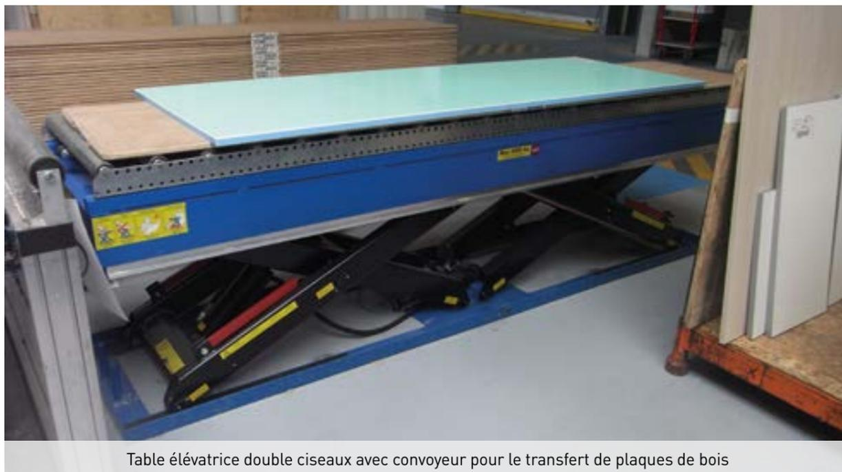
Table élévatrice double ciseaux avec convoyeur pour le transfert de plaques de bois
