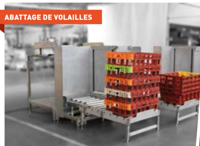
Empileur avec convoyeur intégré, ligne de conditionnement
