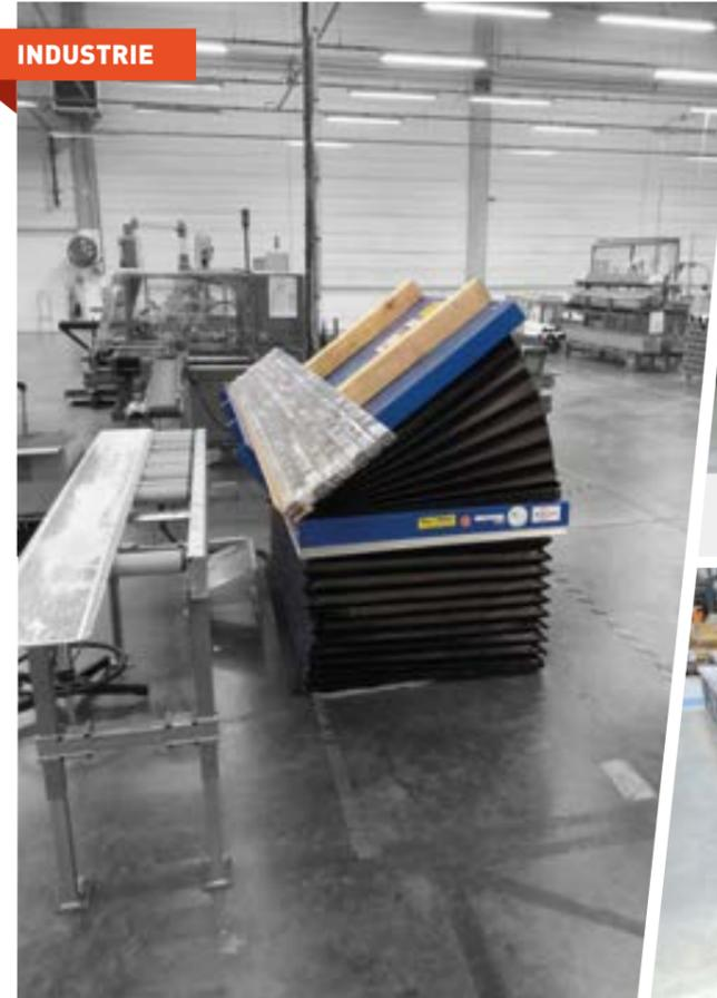
Table élévatrice avec tilt et soufflet de protection, pour la mise à hauteur de profilés aluminium
