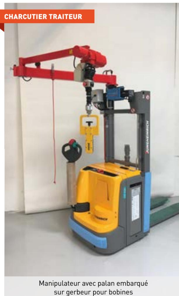
Manipulateur avec palan embarqué sur gerbeur pour bobines
