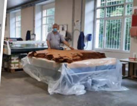
Table élévatrice avec plateau basculant, pour permettre la vérification de la qualité des peaux
