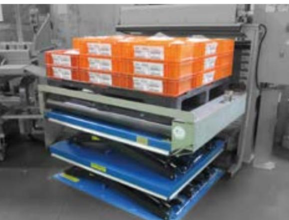
Table élévatrice double avec convoyeur intégré
